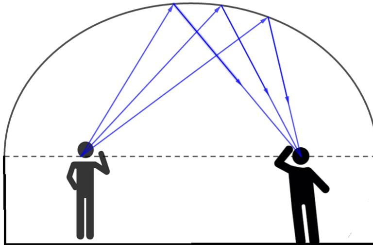
**Figura 4.** Principio del funcionamiento de una galería murmurante.
