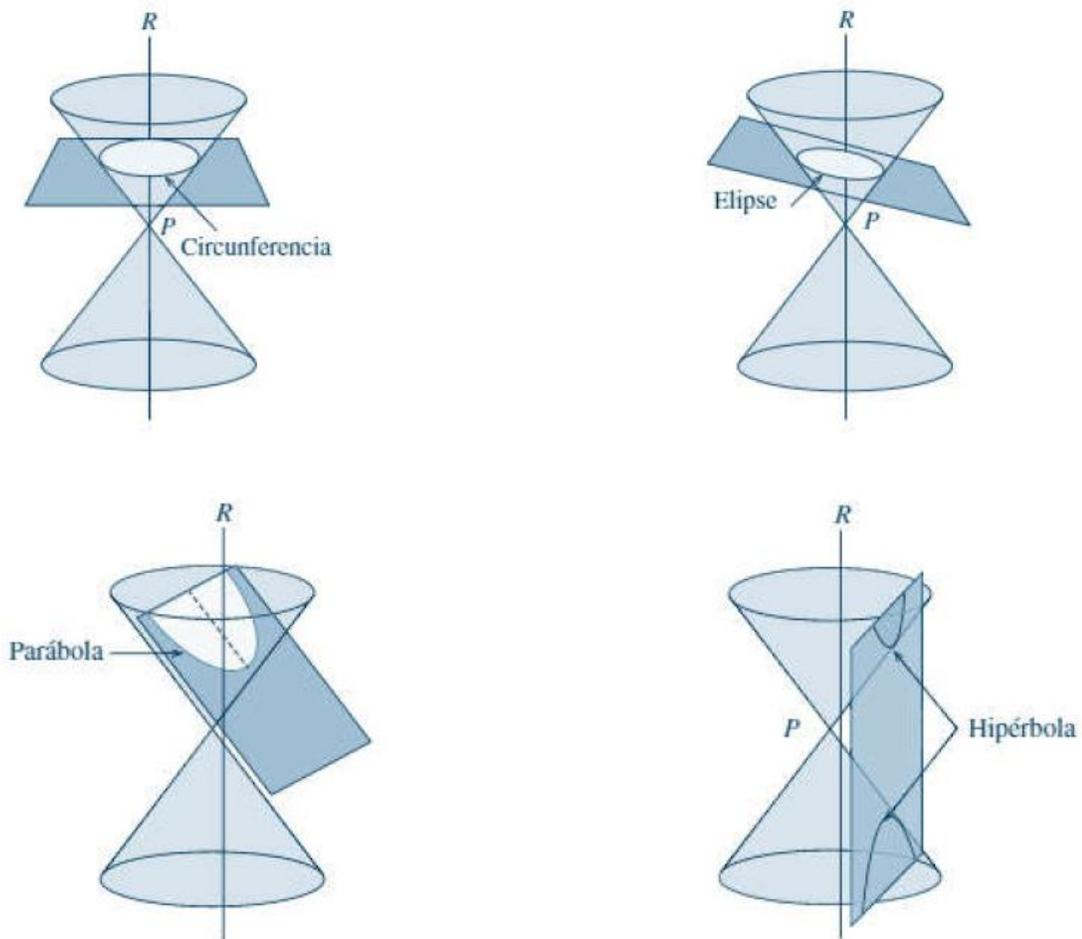
*Figura 1 Formación de las cuatro cónicas básicas.*
