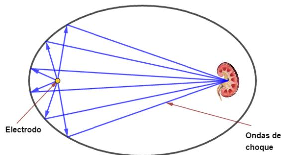
Figura 3. Principio del funcionamiento de un litotriptor.
